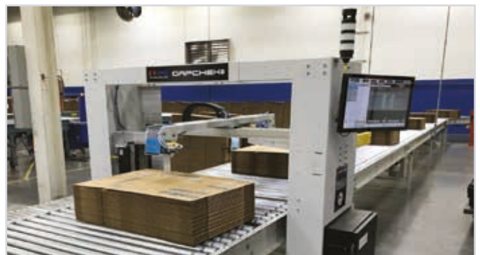
Inspecciona la totalidad de gaps de un paquete
