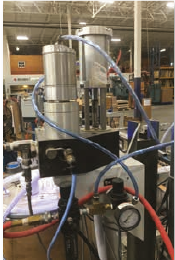
El sistema PFRM-5 es de fácil instalación y de coste competitivo. Incluye bomba de pistón, regulador presión de cola, distribuidor de 4 salidas y filtro de cola.
