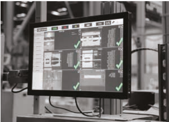
El sistema CartonChek permite una inspección completa de inspección de calidad. Para un sistema completo, puede incorporarse cámaras, sensores y expulsores de producto defectuosos.
