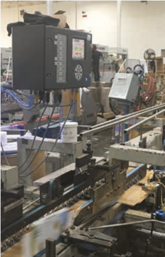
El controlador de disparos MCP-8 tiene capacidad de inspección.
