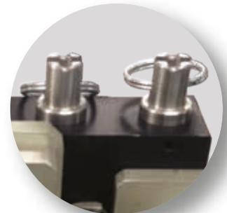
Las anillas de liberación rápida permiten un cambio rápido de la orientación de la estación y sin necesidad de herramientas.
