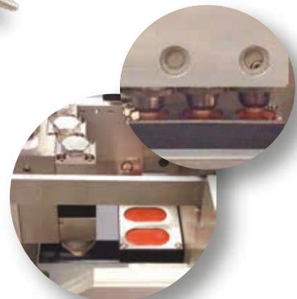
El sellador de puntas para una limpieza automática de boquillas previene el taponamiento durante los períodos de inactividad. Este se retira de forma automática cuando el sistema se pone en marcha.
