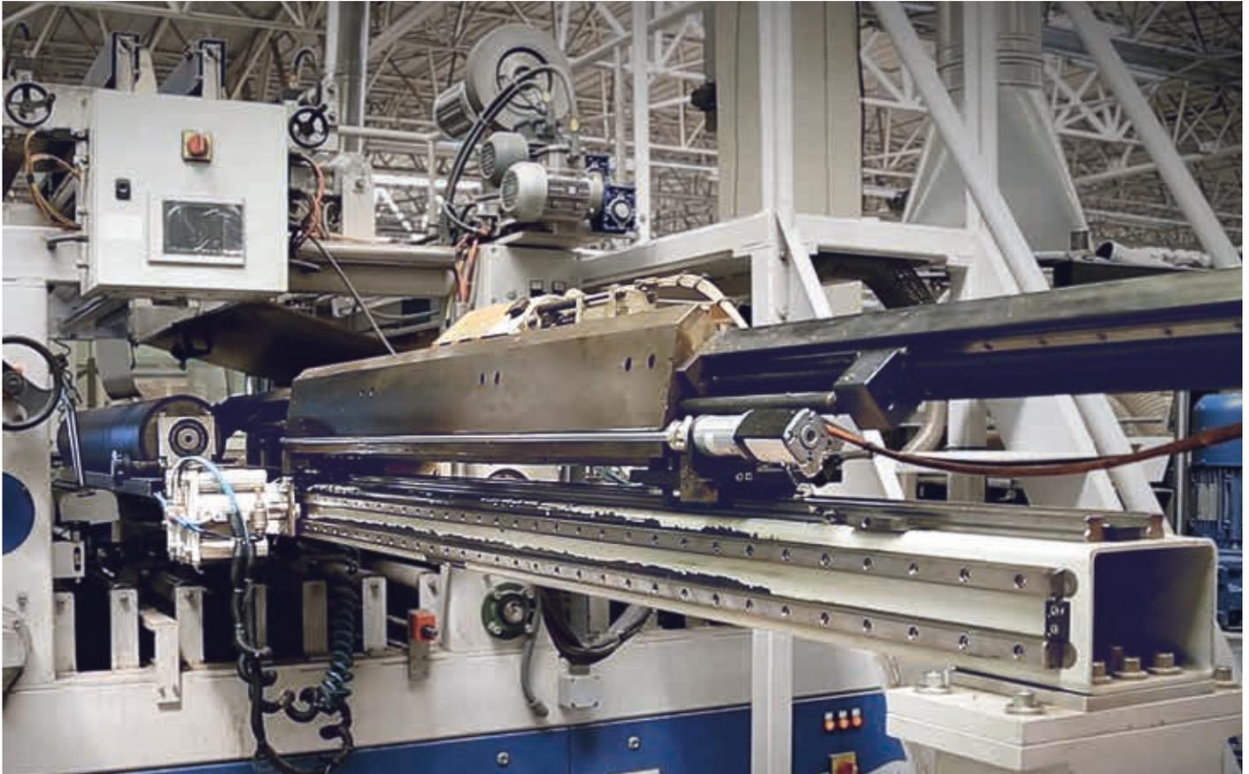
Sin rayas. La varilla motorizada evita que los contaminantes queden atrapados entre el cabezal y el sustrato
