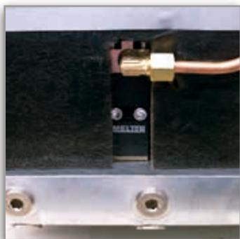
Válvula de seguridad que descarga presión del sistema para un mantenimiento y servicio seguro.
