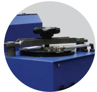
Depósito con cierre hermético y sistema de soplado de aire
