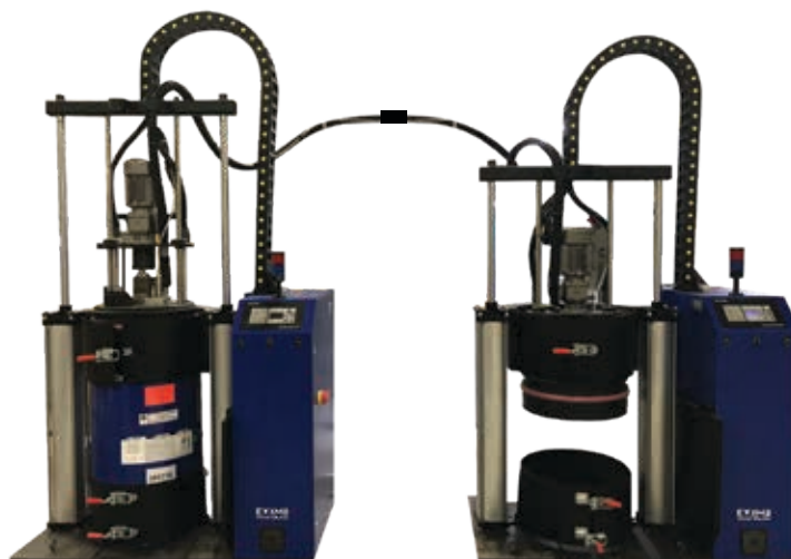
Dos platos pueden trabajar en tandem. Cuando el primero está vacío, automáticamente pasa al segundo.
