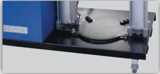
Integra un nuevo sistema de sujeción para agilizar el cambio de bidones.
