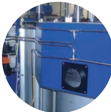
Campana extractora de gases opcional para conectar fácilmente al tubo de ventilación
